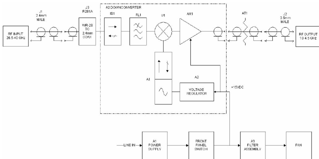
N8975A OPTION K40 BLOCK DOWNCONVERTER BLOCK DIAGRAM
